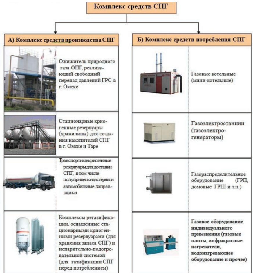
Рисунок 1. Комплекс основного технологического оборудования (комплекс средств СПГ) для реализации предлагаемого проекта по тепло-энергоснабжению
