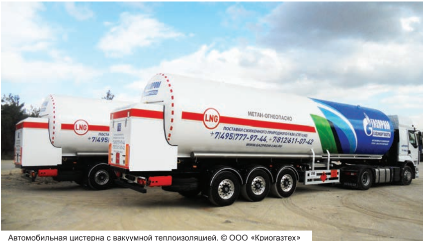
Автомобильная цистерна с вакуумной теплоизоляцией. © ООО «Криогазтех»
